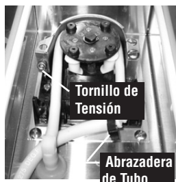
Instale Tubo Nuevo
