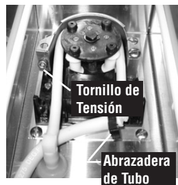
Instale Tubería Nueva
